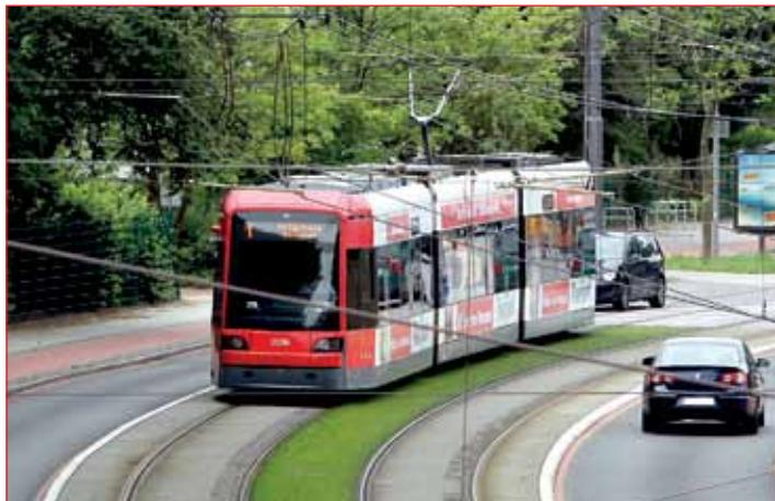
Tenever macht's vor: Die Linie 1 fährt auf neuen Gleisen, links und rechts die weiße Hochpflasterung. Zwischen den Gleisen ist Schotterterrassen, der weitere Gleiskörper asphaltiert. So schick soll es vom 13. September an auch in Gröpelingen aussehen. Foto: BSAG
